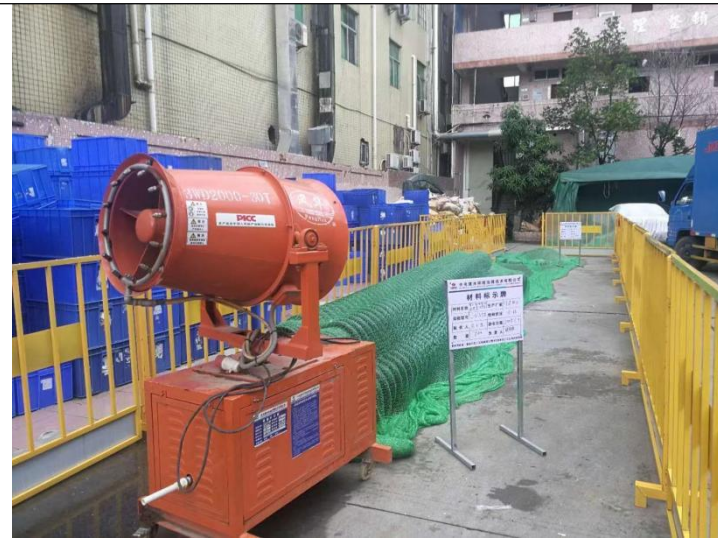
施工期洒水防尘照片
